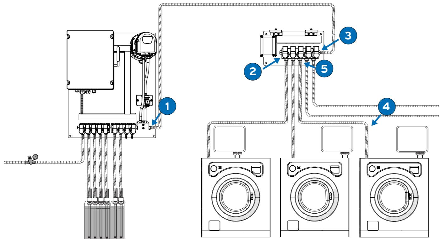
K připojení zařízení, rozdělovače a podložek použijte opletené PVC potrubí 10x16 a svorky z nerezové oceli.
