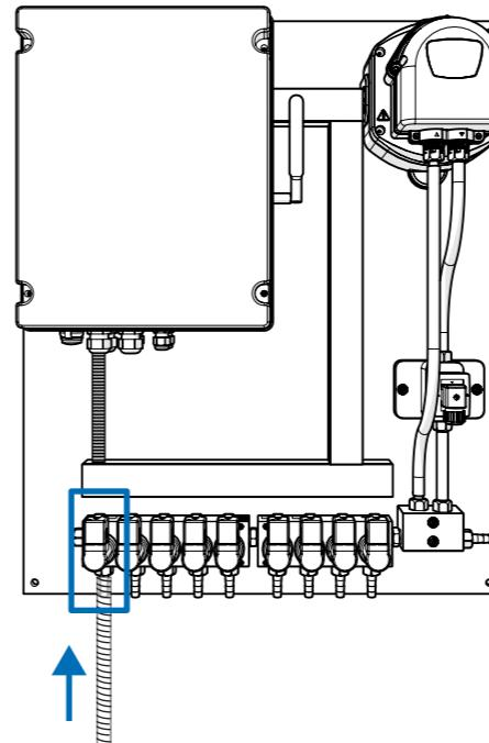
Připojte přívod vody ke krajnímu levému elektromagnetickému ventilu na středovém panelu jednotky.
