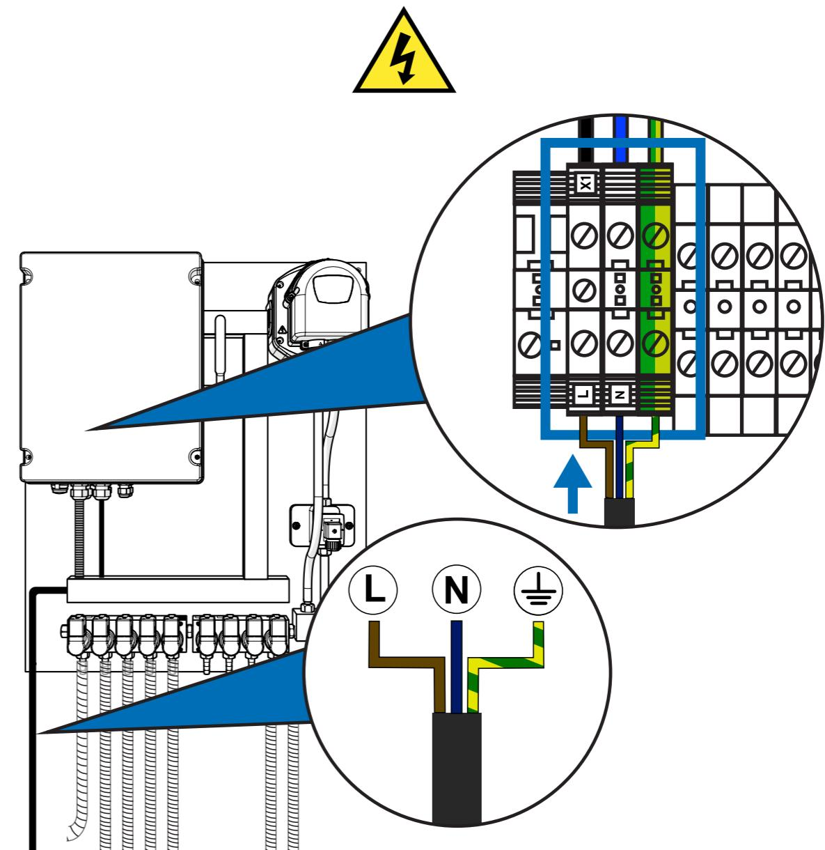
Pro napájení zařízení je nutné použít kabel 3x1,5mm<sup>2</sup>. Kabel prostrčte kanálem umístěným vlevo dole a pomocí jedné z kabelových vývodek jej bezpečně zasuňte dovnitř rozváděče. Připojte ke svorkám označeným X1, které se nacházejí vlevo dole na připojkách.
