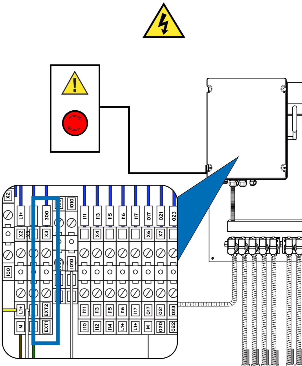
Chcete-li k jednotce připojit tlačítko nouzového zastavení, můžete použít výše uvedený slot pro konektory EXT1 a EXT2.
