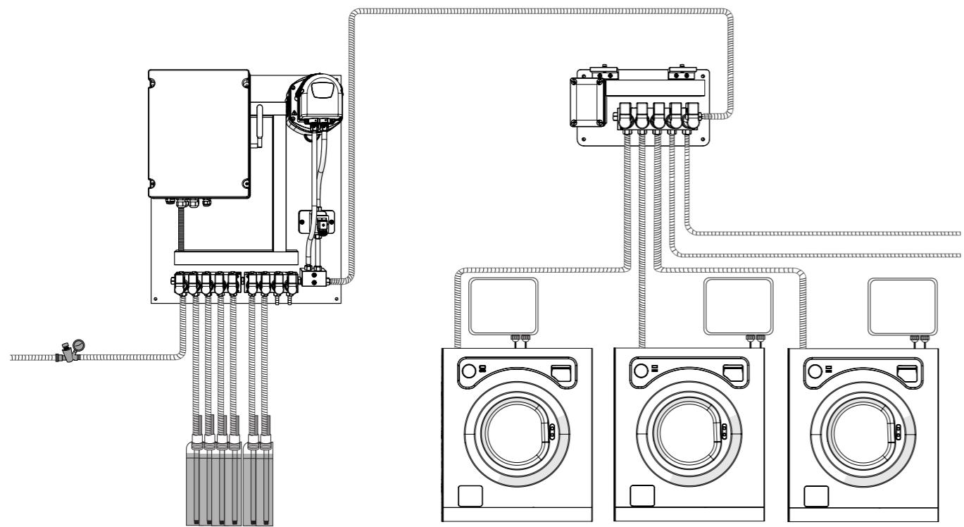
Tento obrázek reprodukuje "standardní" nastavení jednotky Multiplex s jedním kanálem, přičemž "kanálem" se rozumí skupina výrobků, které jsou vstřikovány do stejného rozdělovače a směřují do rozdělovače (pračky) nebo vstřikování (tunel).
