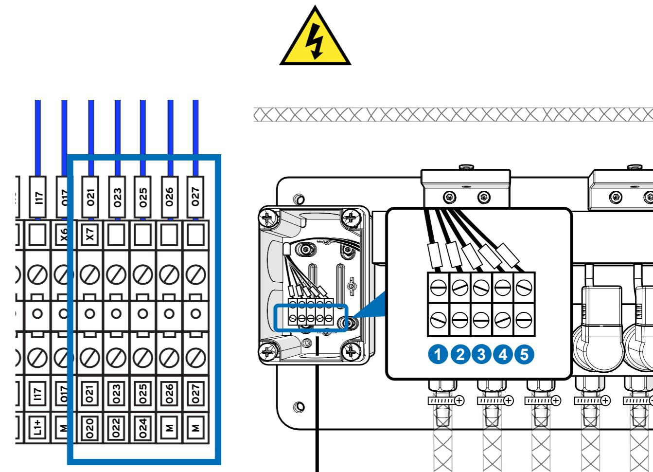
Pro spojení mezi řídicí kabinou a rozdělovačem použijte kabel 7x1mm<sup>2</sup>. Připojte rozdělovač ke svorkovnici X7. Každé připojení svorek odpovídá zásuvkám očíslovaným zleva doprava, přičemž jejich počet závisí na pořadí. Níže je uvedeno schéma zapojení hlavní jednotky.
